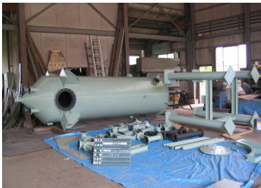
活性炭吸着塔
