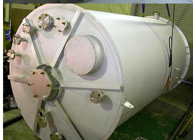
薬品貯蔵タンク
