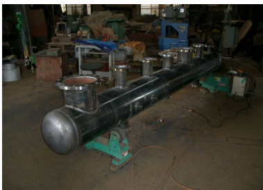
蒸気ヘッダー管
