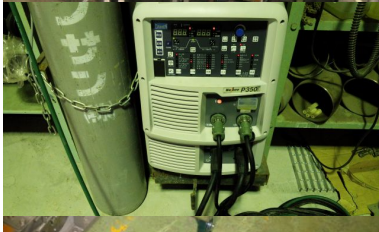
アルミ半自動溶接
