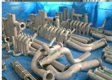
■ プレハブ配管製作
