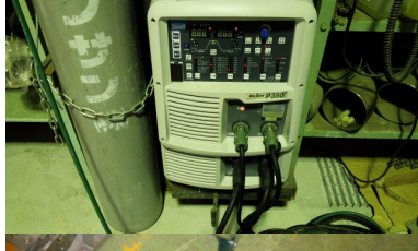
■ アルミ半自動溶接
