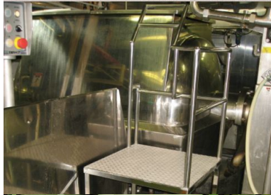
■ 食品工場 点検架台
