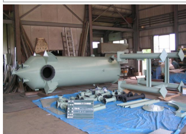
■ 活性炭吸着塔
