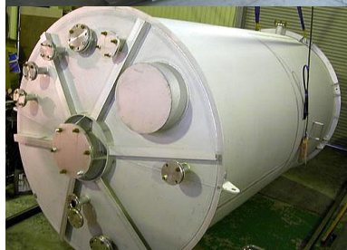
■ 薬品貯蔵タンク
