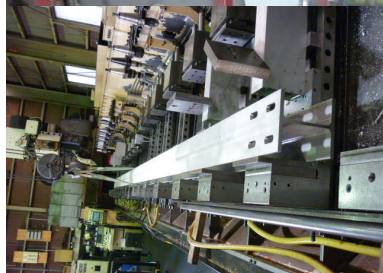
■ ステンレスH形鋼長穴加工
