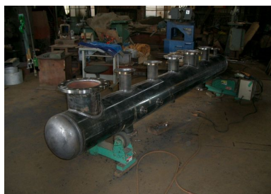
■ 蒸気ヘッダー管
